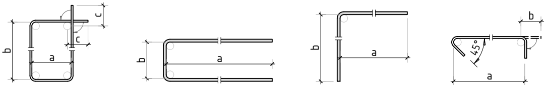
Схема образмеривания деталей по типам
